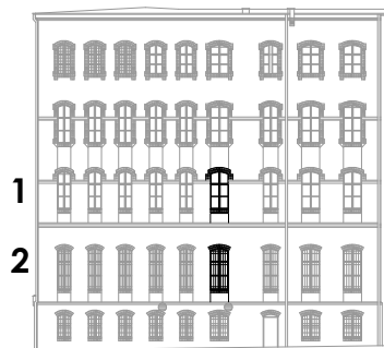
SCHEMAT OKIEN O NR 2 KONSTRUKCJA I DETALE JAK OKNA NR 1 SKALA 1:50
